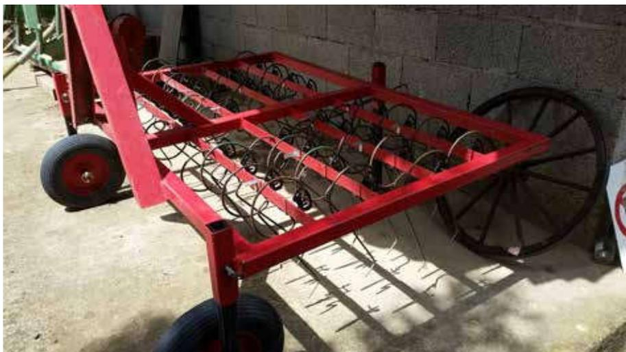
**Bild 3:** Selbstgebauter Beetstriegel mit einzeln verstellbaren Zinken.
